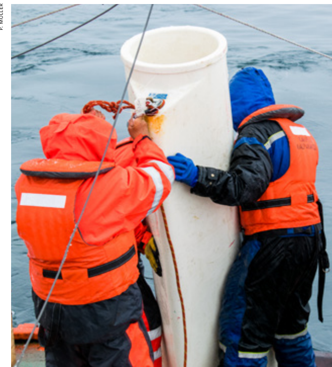
3 Primer anclaje oceanográfico del proyecto FONDAP-IDEAL en bahía Sur, Isla Doumer (lugar donde se ubica la base científica "Yelcho", del INACH). Izquierda: instalación de la línea con sensores de temperatura, salinidad y presión parcial de CO 2 . Derecha: instalación de la trampa de sedimento automática.
